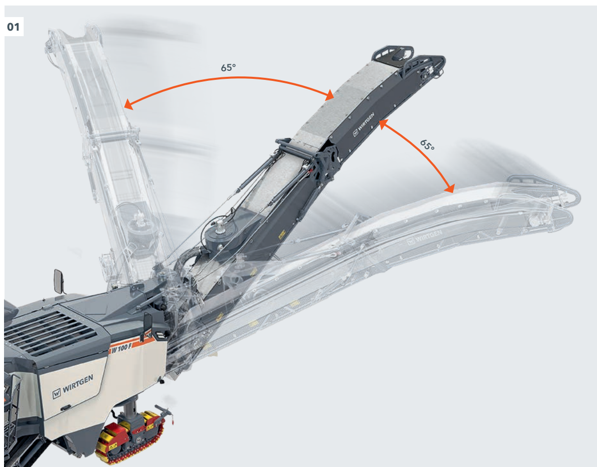
01 Zona de giro extremadamente grande de la cinta de descarga.
